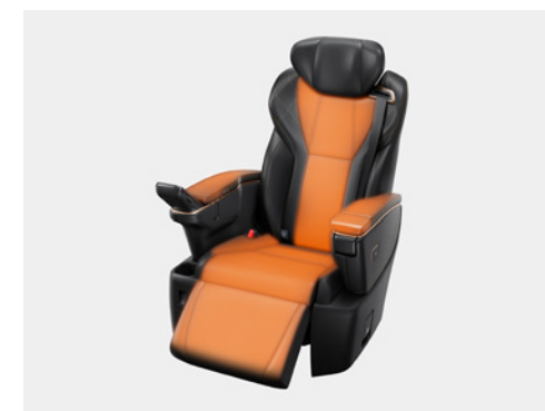
オレンジは、ヒーター加温箇所
