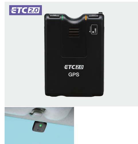
GPS内蔵ETCアンテナ装着例
