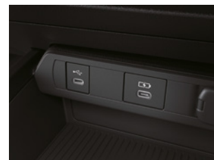
Ⓚ通信/充電用USB端子 (Type-C/センターコンソール前部1個) Ⓛ充電用USB端子 (Type-C/センターコンソール前部1個)
