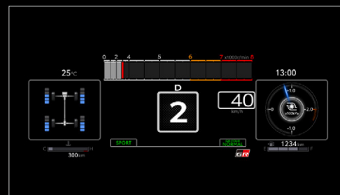
横タコバー表示 カスタム例① 中央:ギヤ段 左:4WD作動状態 右:ブースト計
