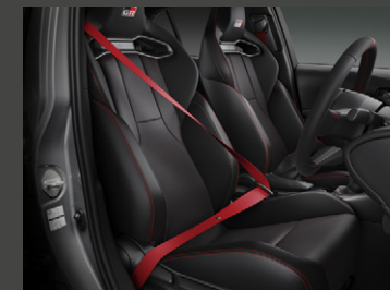
ELR付3点式レッドシートベルト (プリテンショナー& フォースリミッター機構付【フロント】)
