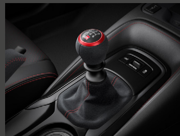
ウルトラスエード®巻きシフトノブ (アルマイトレッド 塗装リング/GRロゴ付)+シフトレバーブーツ (ウルトラ スエード®/レッドステッチ付)
