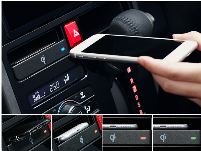
スマートフォン(大)充電時 スマートフォン(中)充電時 充電中:オレンジ 充電済:グリーン
