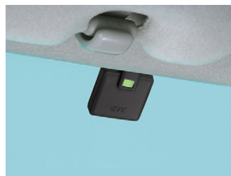
ETCアンテナ装着例
