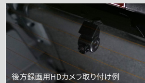
後方録画用HDカメラ取り付け例
