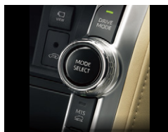
ドライブモードセレクトスイッチ ■写真はZX(ガソリン車)。
