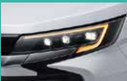
S-Zにメーカーオプションのプロジェクト式LEDヘッドライト(オートレベリング機能付き)+LEDターンランプ+LEDクリアランスランプ(デイトライト機能付き)
