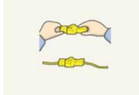
電気配線の接続部のゆるみ・損傷
